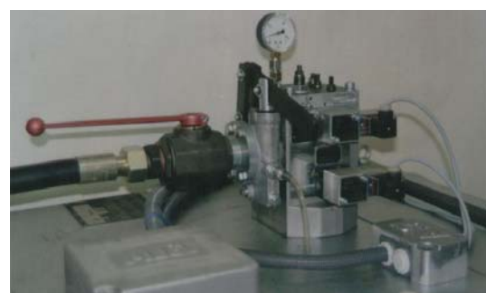
Řídicí jednotka agregátu s ventily
